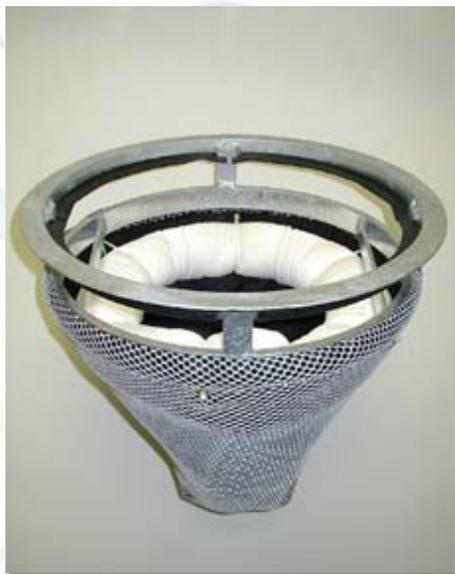
Struttura semi rigida costituita da un filtro per sedimenti in polipropilene non tessuto e rete in poliestere; dotata di un cuscino filtrante selettivo per oli/idrocarburi
